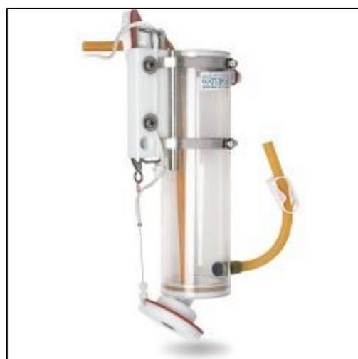
Figure 14 : Bouteille Van Horn utilisée lors des prélèvements d'eau
