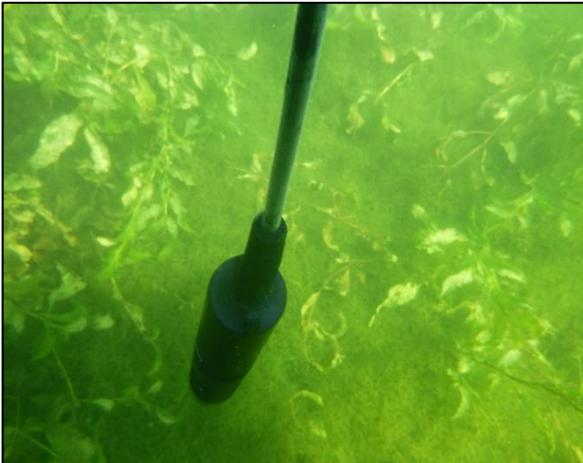
Figure 30 : Sonde relevant la concentration d'oxygène dissous au-dessus de macrophytes
